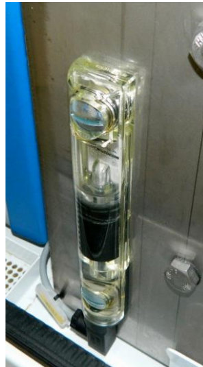
Slika 16: Indikator nivoja hladilne tekočine
