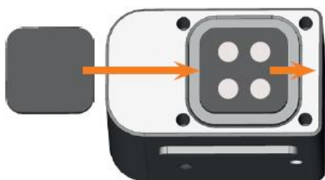
Slika 47: nova podložka (na levi, brez lukenj) zamenja staro (na desni, z luknjami)
