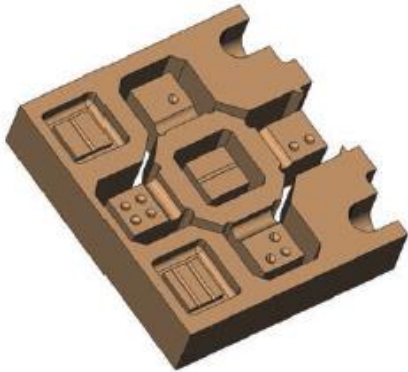
Slika 43: testno telo za CC CHIC po rezkanju
