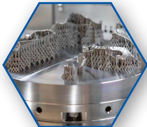
Kvaliteta i stabilnost zrake i 200-vatna snaga lasera osiguravaju optimalne i dosljedne uvjete za proizvodnju visokokvalitetnih komponenti. Mala laserska točka izvrsne rezolucije idealna je za izradu vrlo složenih i delikatnih dijelova. Printera EOS M 100 i E PLUS M150 idealna sta za za ispis dentalnih krunica i mostova, kao i drugih medicinskih naprava.
