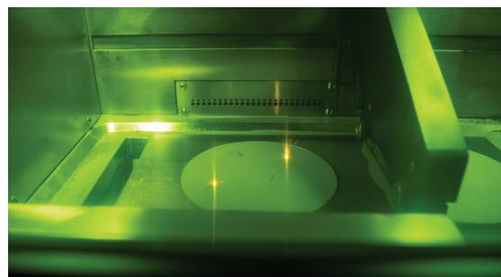
Kvaliteta i stabilnost zrake i 200-vatna snaga lasera osiguravaju optimalne i dosljedne uvjete za proizvodnju visokokvalitetnih komponenti. Mala laserska točka izvrsne rezolucije idealna je za izradu vrlo složenih i delikatnih dijelova. Printer je idealan za ispis dentalnih krunica, mostov i ljevanih baz proteza, kao i drugih medicinskih naprava.
