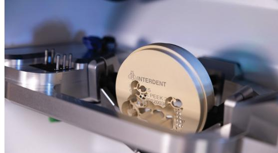
Frezanje se vrši na suvremenim Interdent jedinicama za frezanje koje svojim sofisticiranim strategijama procesa frezanja osiguravaju neprevaziđenu preciznost i zavidnu površinsku obradu.
