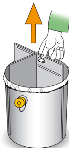
При очистке ослабить винтик на сливе, отвинтить крышку, слить воду и вынуть коллектор.
